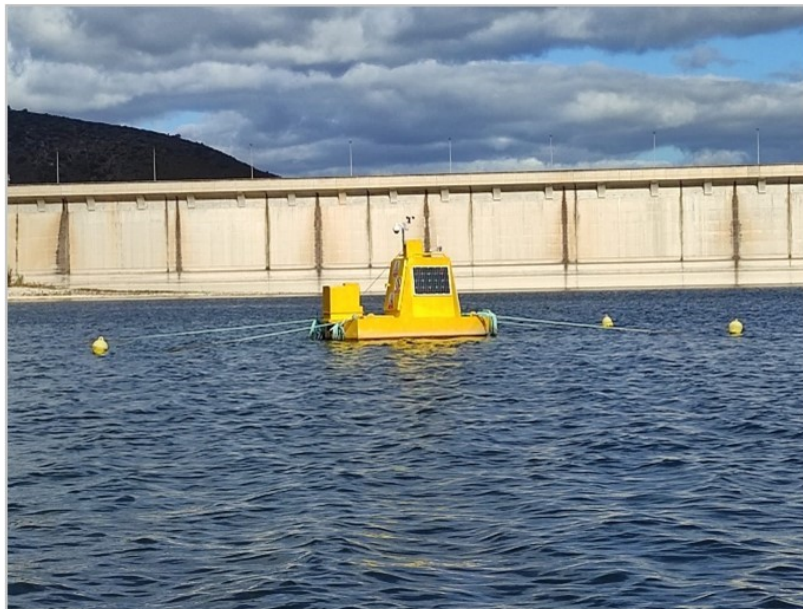
Plataforma flotante de seguimiento de la calidad instalada en el embalse de Bellús.
